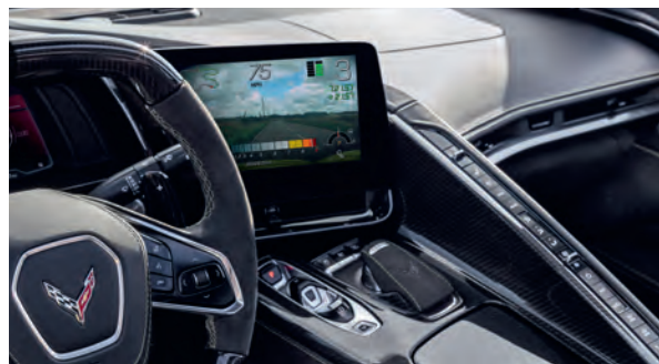
Performance Data Recorder zur Analyse von Rennstreckenrunden.
